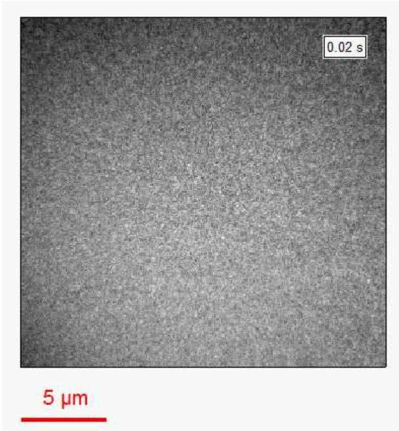
$T > 800 \text{ C}; P = 2 \cdot 10^{-8} \text{ mbar ethylene}$
